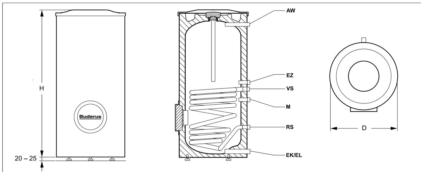
Рис. 2 Размеры и подключения (в мм) – принципиальная схема
